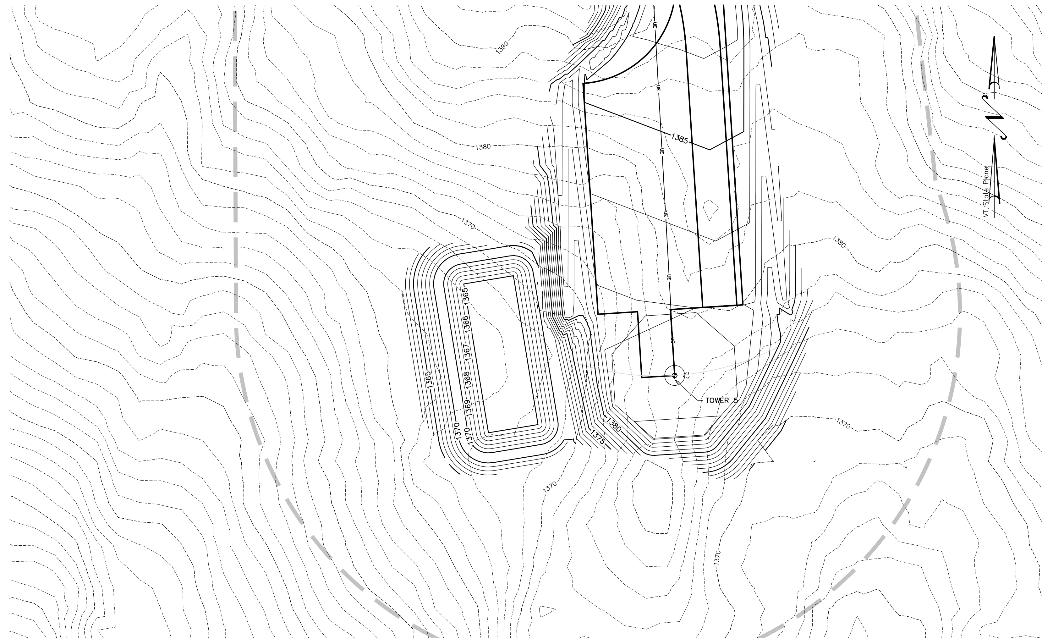
04 Sediment Trap 1 C-17 SCALE: 1" = 30'
